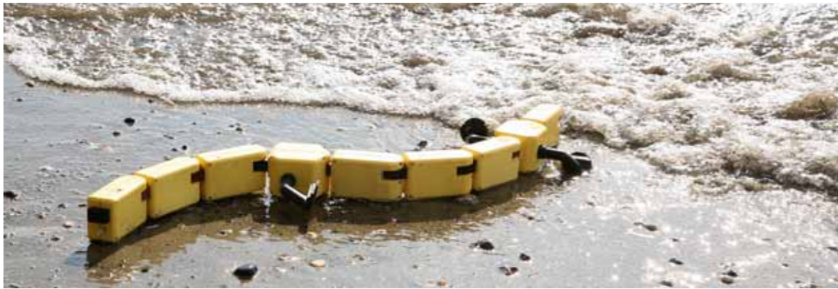
Abb.: Der biologisch inspirierte amphibische Salamandra Robotica mit Sensor-Motor-Kopplung in Form von künstlichem Rückenmark
