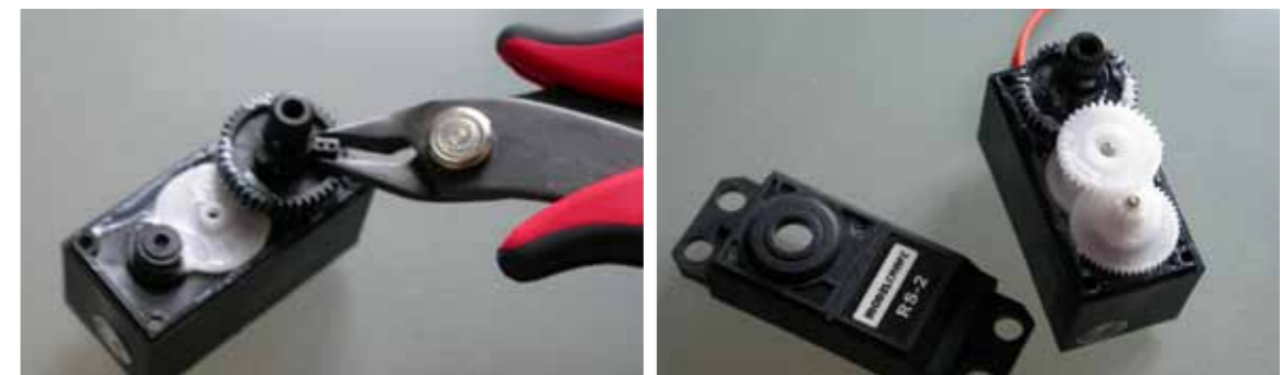
Jetzt muss man nur noch die mechanische Sperre an einem der Zahnräder abknipsen und den Servo wieder zusammenbauen
